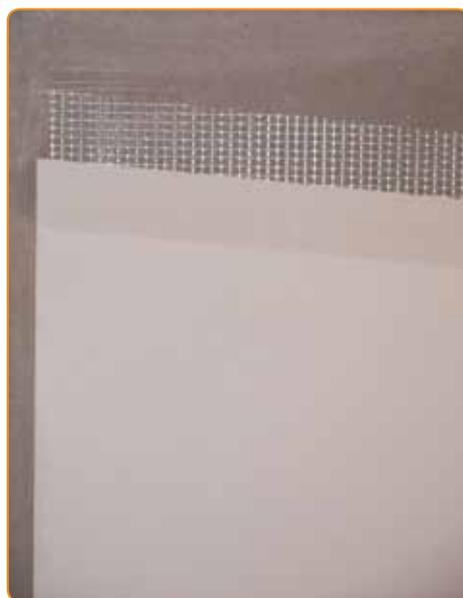
Treillis en fibres de verre, carreaux de 6 mm
