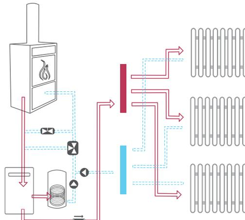
Chaudière à gaz/mazout avec ECS
