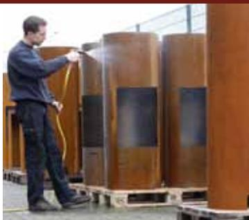
Les revêtements des poêles-cheminées confectionnés à la main sont exposés aux éléments pour permettre la formation d'une couche de rouille optimale.
